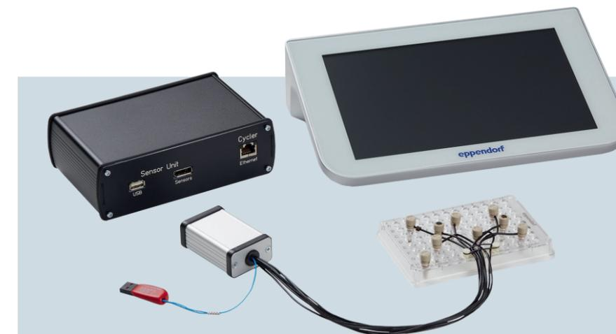
La vérification de la température avec un système à plusieurs sondes permet une évaluation rapide et fiable de la performance du cycleur. Les certificats générés qualifient votre appareil au sein de votre système de gestion de la qualité.
