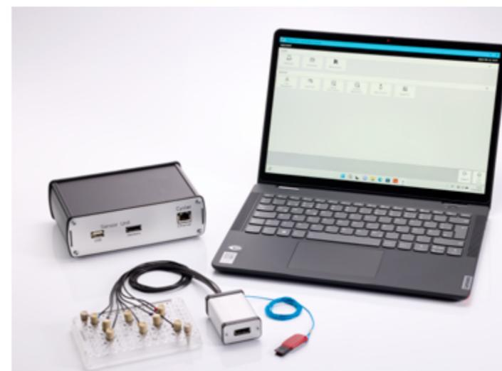
La vérification de la température avec un système à plusieurs sondes permet une évaluation rapide et fiable de la performance du thermocycleur. Les certificats générés peuvent prendre en charge la qualification des appareils pour votre système de gestion de la qualité.
