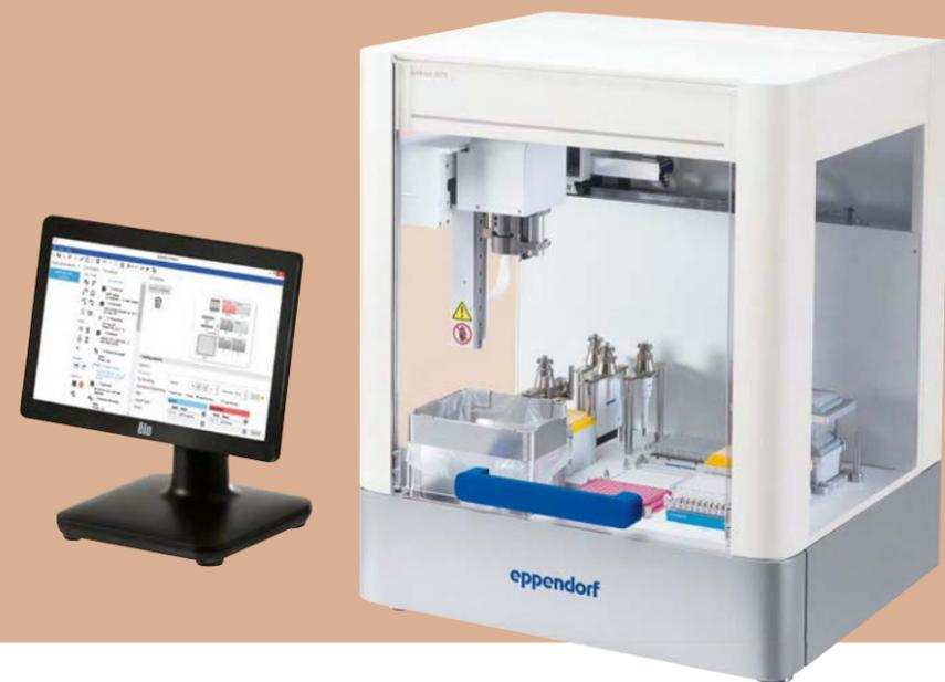
Le système automatique de manipulation des liquides **epMotion 5073t** vous permet de préparer rapidement et facilement une bibliothèque NGS de 1 à 24 échantillons. Il convient également parfaitement pour automatiser de longues tâches de manipulation des liquides plus complexes, telles que l'extraction de l'ADN/ARN. Gagnez du temps et améliorez la reproductibilité de vos résultats avec l'epMotion 5073t !
