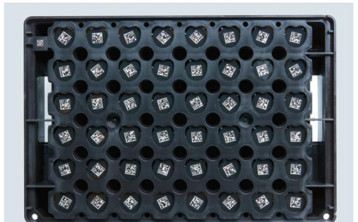
Avec l'Eppendorf RackScan et le logiciel, vous pouvez scanner plusieurs flacons en parallèle et transférer les données des échantillons vers votre logiciel de gestion des échantillons, par exemple eLABInventory ou des banques de données externes
