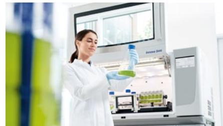
Innova S44i è disponibile anche con sistema per luce LED fotosintetica per la crescita di cellule di alghe o piante.
