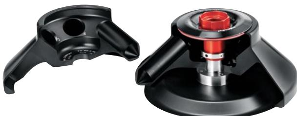
Sezione trasversale del Rotore FA-6x50 (6 provette coniche da 50 mL) che mette in risalto il design del rotore a peso ridotto. Tutto il metallo non necessario per la sicurezza o le prestazioni viene reso cavo per ridurre il peso e migliorare la maneggevolezza.
