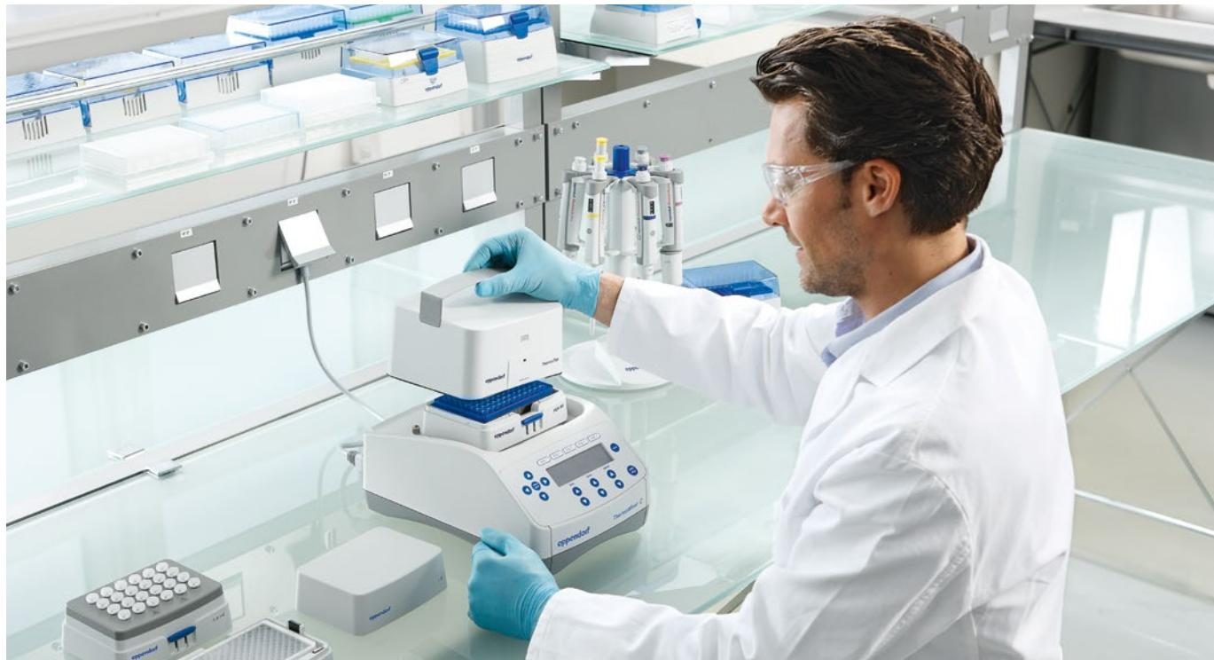
In tutti i laboratori c'è bisogno di riscaldare, raffreddare e miscelare i campioni. Purificazione e analisi di acidi nucleici o proteine, ricerca su cellule e tessuti oppure profiling di espressione: tutte queste applicazioni richiedono l'utilizzo di un miscelatore termico.
