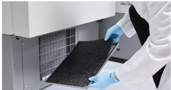
**Come pulire i filtri dell’ultracongelatore?** La sostituzione del filtro è semplice: basta aprire la copertura del filtro e inserire un filtro pulito
