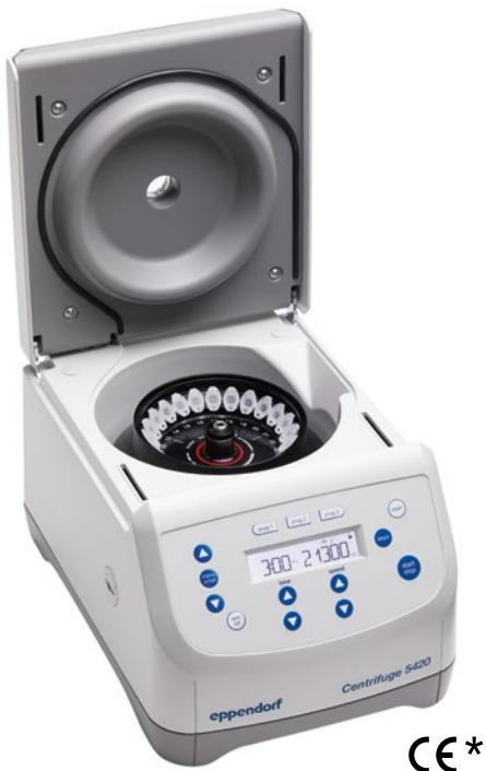
\* Il modello Centrifuge 5420 è una centrifuga non automatica per la separazione di miscele di sostanze liquide del corpo umano, appositamente progettata per essere utilizzata come accessorio insieme a un dispositivo diagnostico in vitro e destinata a essere impiegata per gli scopi previsti. Questo prodotto è conforme ai requisiti della direttiva UE sulla diagnostica in vitro (IVDR) 2017/746.
