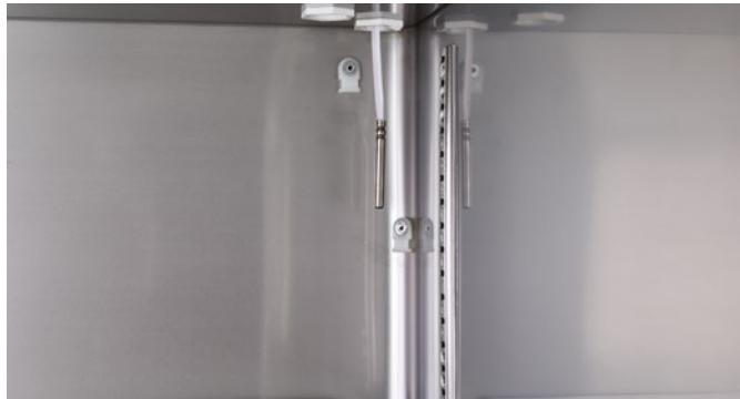
**Doppia sicurezza per i campioni?** La sonda di temperatura incorporata può essere supportata dal sistema di misurazione indipendente della temperatura diVisioNize® sense
