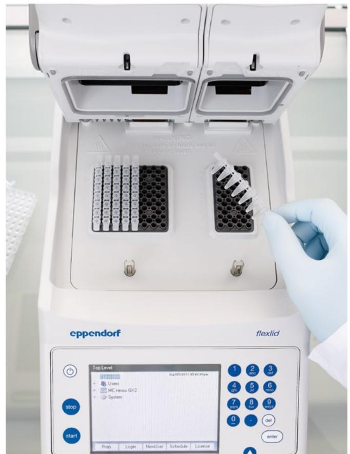
Eseguite due PCR separate contemporaneamente con Mastercycler® nexus X2
