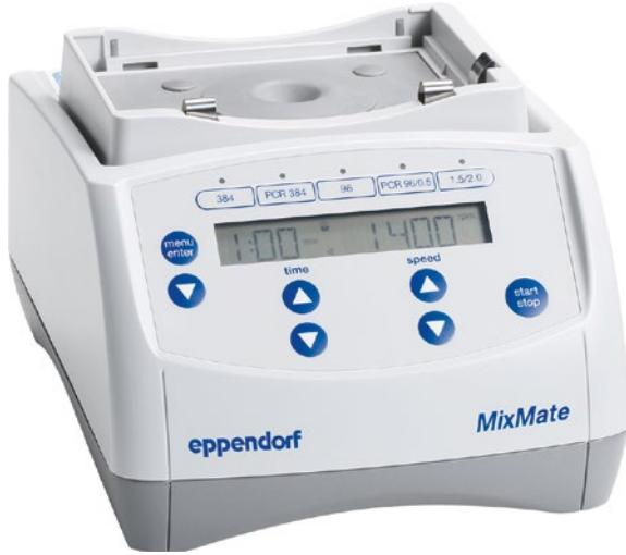
**Una vera miscelazione?** Il miscelatore 3 in 1 per piastra, provette e miscelazione con funzione vortex. Questo strumento ad alta velocità offre una miscelazione completa dei vostri campioni in pochi secondi. L'eccezionale <sup>2D</sup>Mix-Control permette di effettuare una miscelazione ottimizzata grazie alla sua tecnologia anti-spill.
