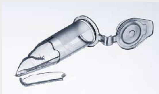
Figura 2: Provette della concorrenza danneggiate per centrifugazione con sollecitazione troppo elevata (G e A).
