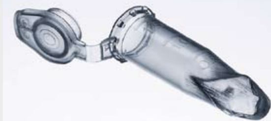
Figura 2: Provette della concorrenza danneggiate per centrifugazione con sollecitazione troppo elevata (G e A).
