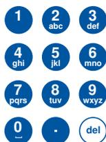
Immettere numeri e testo in campi di immissione. Nei campi di immissione numerici (ad es. temperatura, tempo) i tasti sono occupati solo da numeri. Per i numeri decimali con posizioni dopo la virgola, utilizzare il punto come separatore decimale. Nei campi di immissione alfanumerici, i tasti sono occupati da più lettere o numeri.
