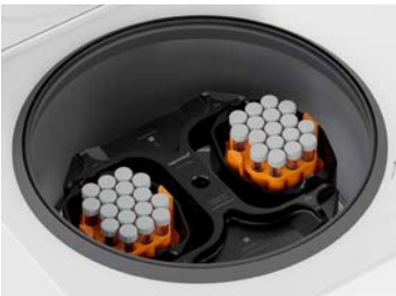
Adattatore universale 1 Adatto per piastre deepwell ed Eppendorf Tubes® 5.0/15 mL.
