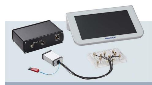
Verifica della temperatura con un sistema multisonda che consente una valutazione rapida e affidabile della prestazione del termociclatore. I certificati generati documentano la qualifica degli strumenti per il sistema di gestione della qualità.
