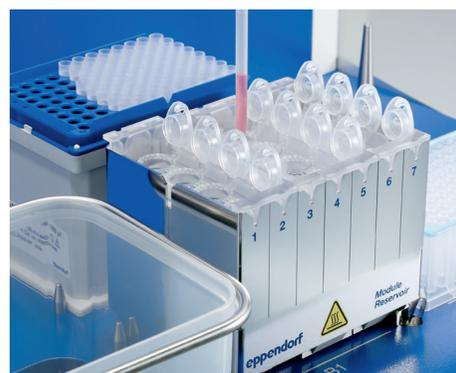
Semplice implementazione del dispositivo automatico di pipettaggio epMotion
