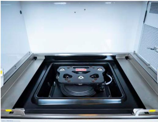
**Funzionamento senza vibrazioni né problemi per anni:** il carico della piattaforma è sostenuto da tre assi portanti, nove cuscinetti a sfera a lubrificazione permanente e dall'ampia superficie di supporto della piattaforma.
