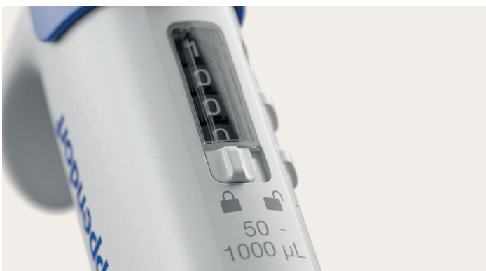
図11: Research 3 neoの容量ロック機能 容量を調整するにはトグルを右にスライドさせ(錠が開いたマーク)、ロックするには左にスライドさせてください(錠が閉まったマーク)。
