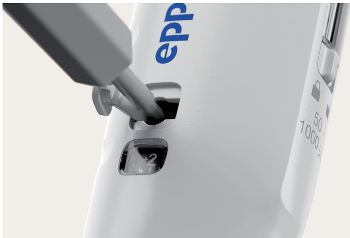
図6: Research 3 neoの一時調整用開口部の写真。下のウィンドウに、行われた調整の数値インジケータが表示されています。付属のツールが調整口に差し込まれており、これにより一時調整を行うことができます。インジケータをゼロに戻すと、ピペットは工場出荷時のキャリブレーション設定に戻ります。
