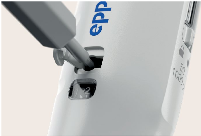
Figure 6: Research 3 neo의 임시 조정 기능을 보여 주는 도식, 아래쪽 창에는 수행된 조정 값을 숫자로 표시합니다. 동봉된 도구가 조정 오프닝에 삽입된 모습이 나타나 있으며, 이를 이용해 임시 볼륨 설정을 변경할 수 있습니다. 인디케이터를 0으로 되돌리면 피펫은 원래의 교정 상태로 복원됩니다.
