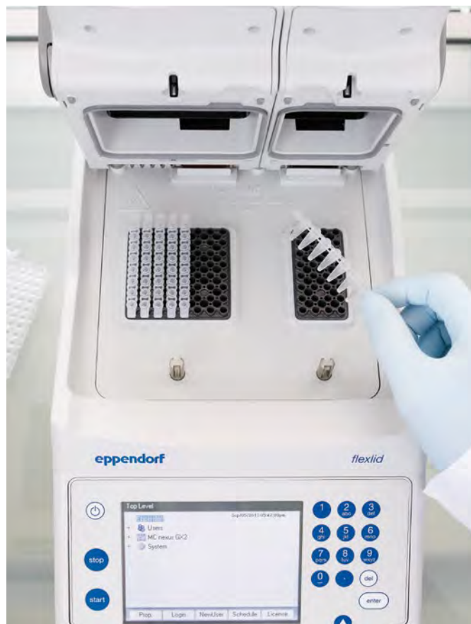
Mastercycler® nexus X2 umożliwia jednoczesne wykonywanie dwóch oddzielnych procedur PCR
