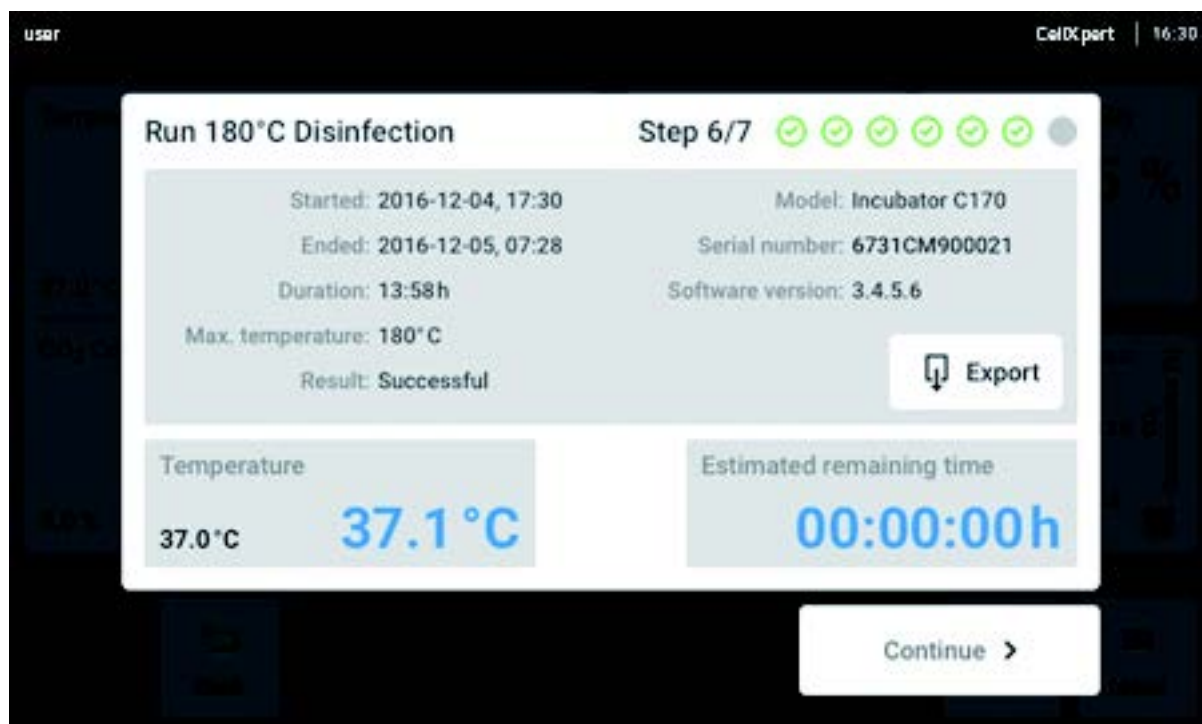
Rys. 10-9: Wyświetlanie wyniku dezynfekcji w wysokiej temperaturze po osiągnięciu temperatury docelowej
