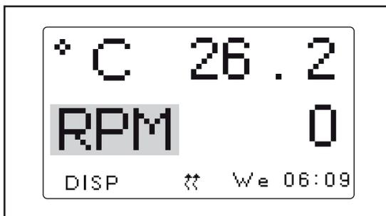
1. Gire o **botão de Controle** para realçar o parâmetro que deseja substituir. Este exemplo mostra a alteração do parâmetro de *RPM* para *HRS*.
