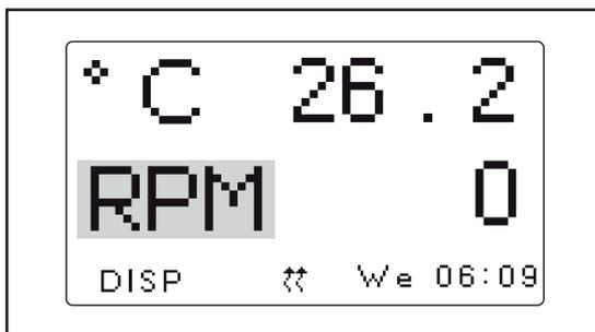
1. Rode o botão para realçar o parâmetro que deseja substituir. Para este exemplo, vamos alterar o parâmetros *RPM* para *HRS*.
