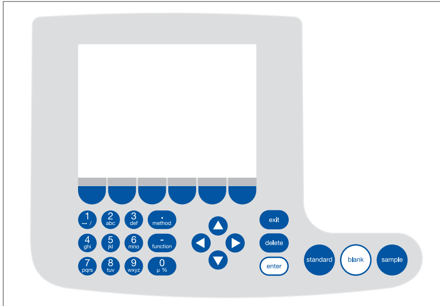
Fig. 5-1: Elementos de comando do BioSpectrometer basic
