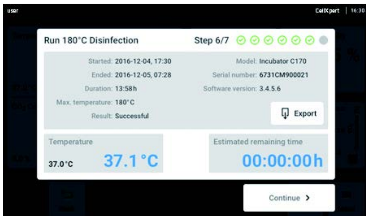
Fig. 10-9: Exibição do resultado da desinfecção a alta temperatura depois de atingir a temperatura pretendida
