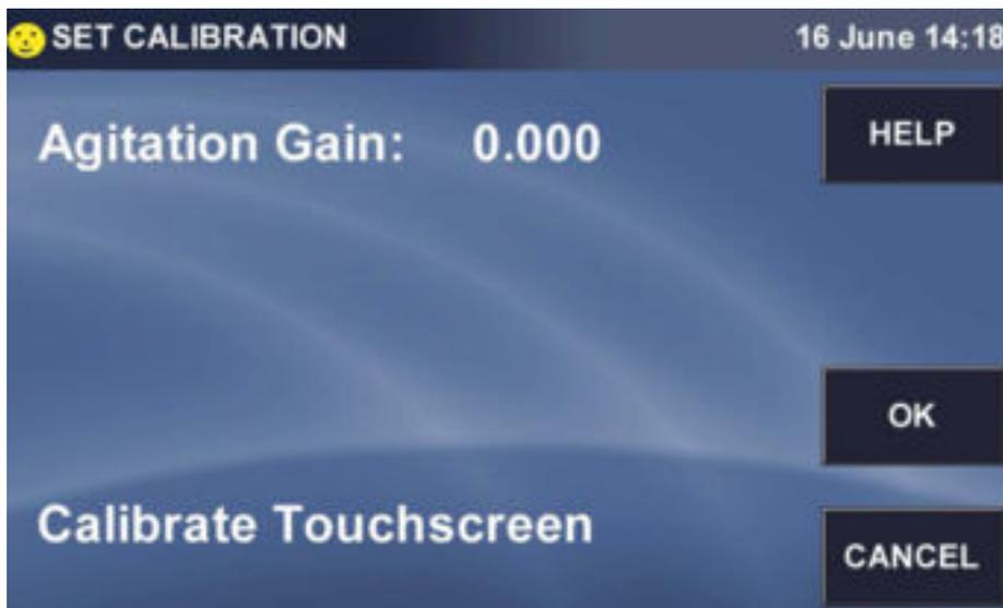
2. Na janela *SET CALIBRATION*, toque na linha *Calibrate Touchscreen*.
