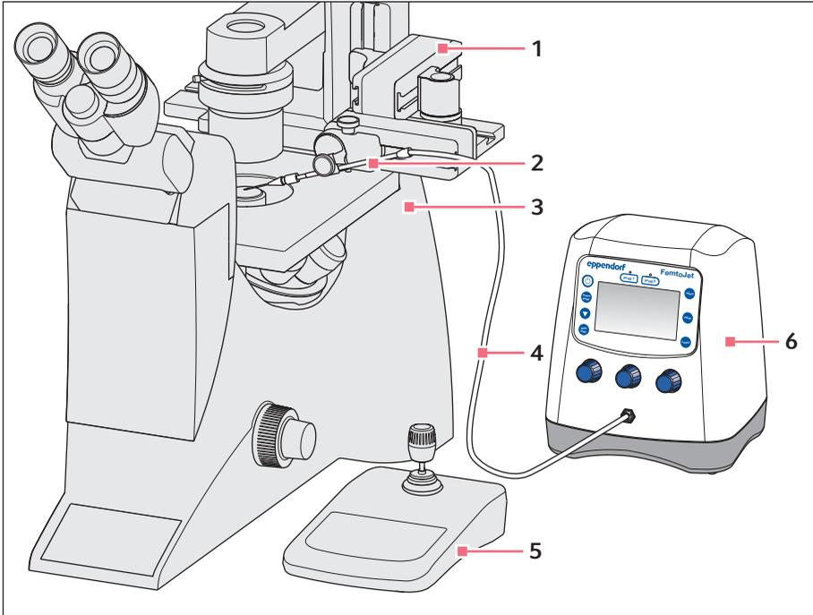
Fig. 3-1: Sistema de microinjeção com FemtoJet 4i
