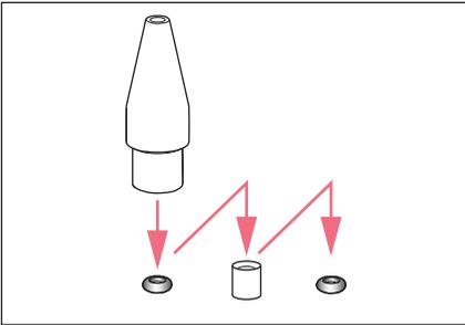
1. Dispor os anéis O-ring e a bucha distanciadora sobre uma superfície plana.
