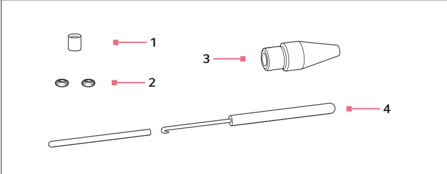
Fig. 8-1: Mandril de aperto 4 com ferramenta de remoção
