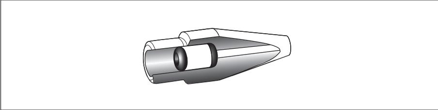
Fig. 8-2: Desenho de corte com os anéis O-ring e a bucha distanciadora posicionados corretamente
