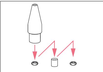
1. Dispor os novos anéis O-ring e a bucha distanciadora sobre uma superfície plana.
