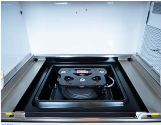
**Funcionamento sem vibrações e sem problemas por anos a fio:** Três eixos de suporte de peso, nove rolamentos de esferas com lubrificação permanente e a grande superfície de contato da plataforma oferecem suporte à carga da plataforma
