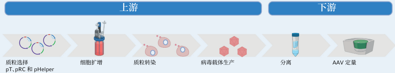
图 1：典型的 AAV-2 载体(衣壳)生产工艺流程。
