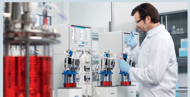
图 4: 使用 SciVario 双联生物反应器控制系统和 BioBLU 1c 一次性生物反应器在分批培养中生产 AAV-2 衣壳。
