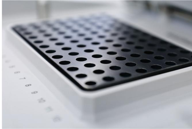
PCR 反应更快。这意味着更快得到实验结果，提升每天的通量，以及更快地达到最佳温度。Mastercycler X50 拥有 10 °C/s 的升温速度以及 5 °C/s 的降温速度。Mastercycler X50 的高速度将成为您的科研优势。
