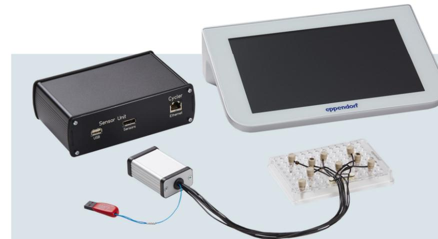
由多个探头组成的温度验证系统可以快捷可靠地评测一台 PCR 仪的性能，生成的证书将清楚地记录该设备是否符合您的质量管理体系。
