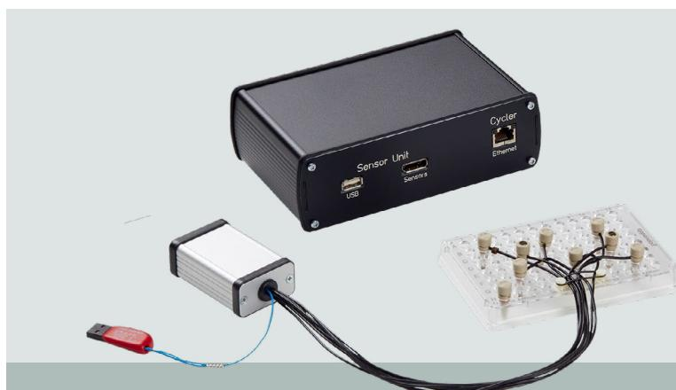
使用多探头系统进行温度验证可快速、可靠地评估 PCR 仪的性能。生成的证书可用于支持质量管理体系的设备确认。
