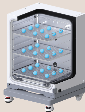
图 1: 符合 DIN 12880:2007-05 规范的检测装置 - 将 27 个温度探头放置在 CO 2 培养箱内部三块搁板上的不同位置
