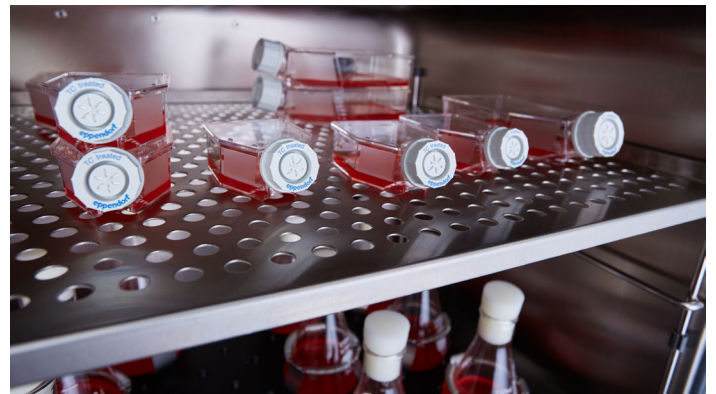
可拆卸的搁板能在振荡培养悬浮细胞时，在相同的条件下培养贴壁细胞。
