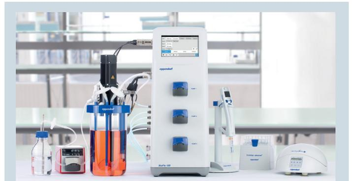
图 3: 配备 BioBLU® 3c 一次性生物反应罐体的 BioFlo® 120 生物反应器控制系统。
