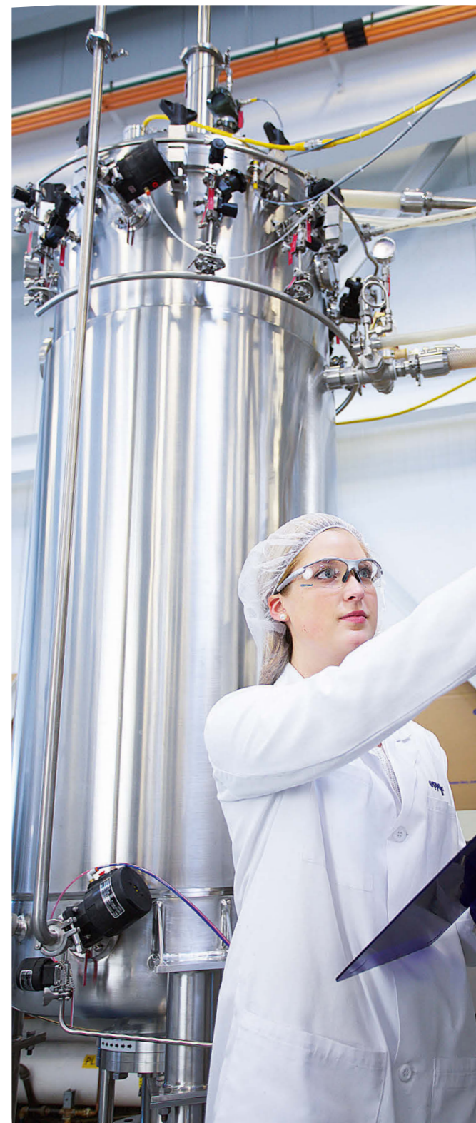
BioFlo Pro Biorreactor y fermentador de esterilización in situ a gran escala, Volumen de trabajo de 45 – 1.200 L
